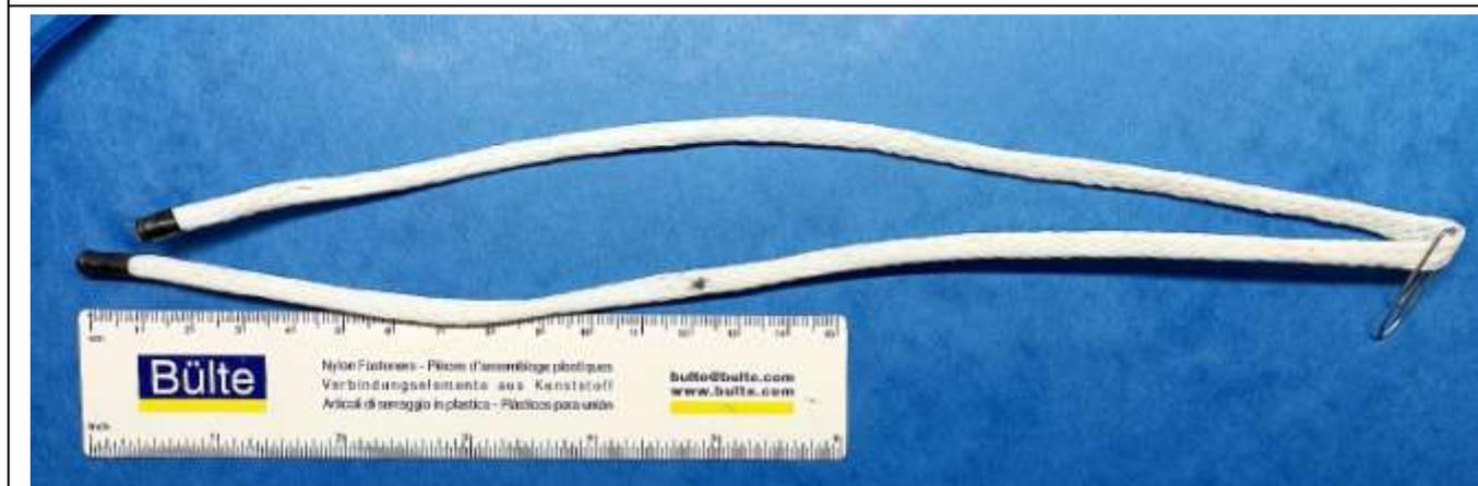
Plier la tresse, avec une branche 8 à 10 mm plus longue car la tresse externe va diminuer en gonflant. Placer un trombonne (ou équivalent) à la pliure, marquer un point à ~120mm de l'extrémité sur la tresse externe
